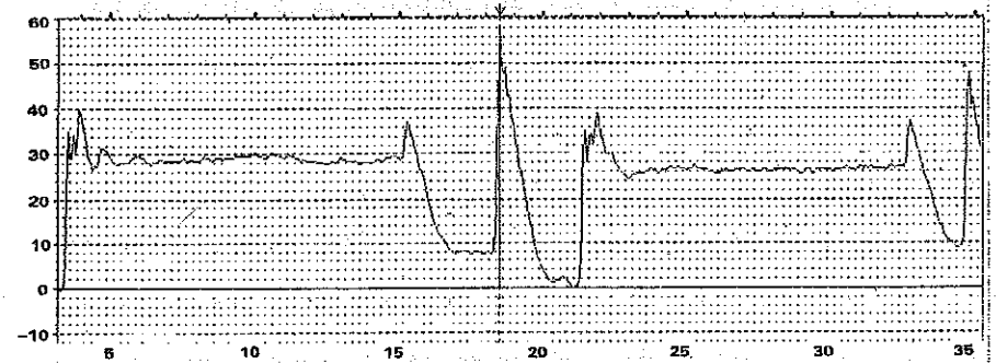
شکل ۱۲-۶ جزئیات نمودار سطح فشار صوتی / زمان برای دو حرکت آسانسور
