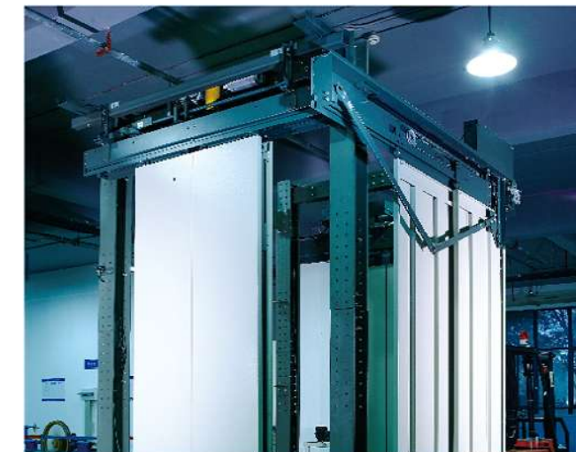
门机测试 Door operator test
