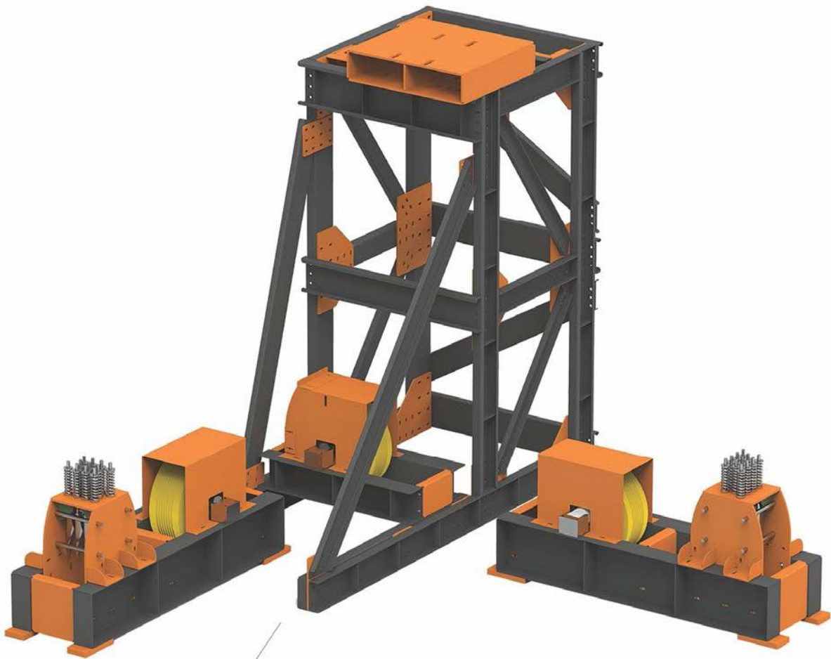
پایه موتور گرلس برای تامین زاویه آلفا Gearless Motor Frame For Alpha Angle Supply
