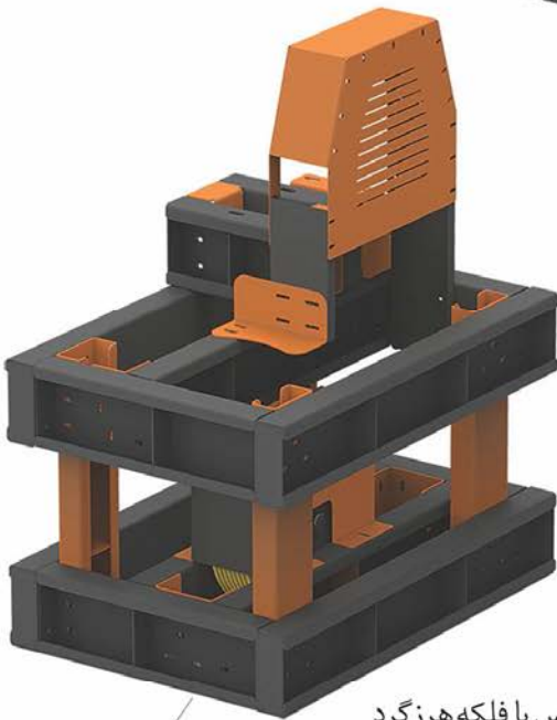
پایه موتور گیربکس با فلکه هرزگرد Pulley Gearbox Motor Frame With Wheel
